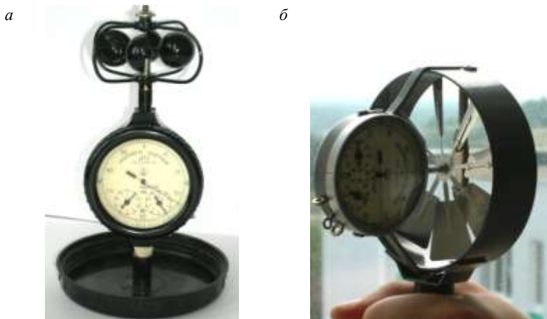
Рисунок 4.1 — Анемометр механический чашечный (а), крыльчатый (б)
