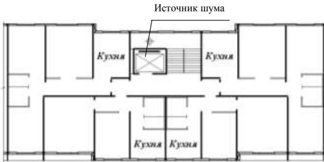
Рисунок 32 — Размещение шумовыделяющих помещений
