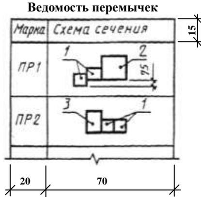
Примечание. Схема сечения может быть дополнена отметками низа перемычек и ориентацией расположения перемычек по отношению к координационным осям.
