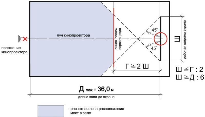
Рисунок 3.25 — Схема плана с определением расчетной зоны расположения зрительских мест в кинозале при плоском экране
