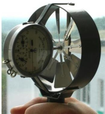
*Рисунок 4.1* — Анемометр механический чашечный (*а*), крыльчатый (*б*)
