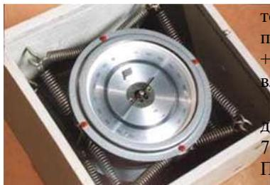
Диапазон измерений атмосферного давления таким барометром от 610 до 790 мм рт. ст. (от 80 до 120 кПа). Пределы допускаемой погрешности измерений  $\pm 0,8$  мм рт. ст.
