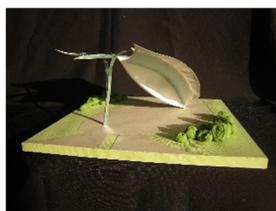
*Рисунок 2.72* — Теневой навес из металлического каркаса с обшивкой композитными панелями и вставками из закаленного стекла.
