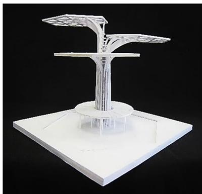
*Рисунок 2.31* — Теневой навес с металлическим каркасом и влагостойкой фанерой. Выполнила Скирденко А.
