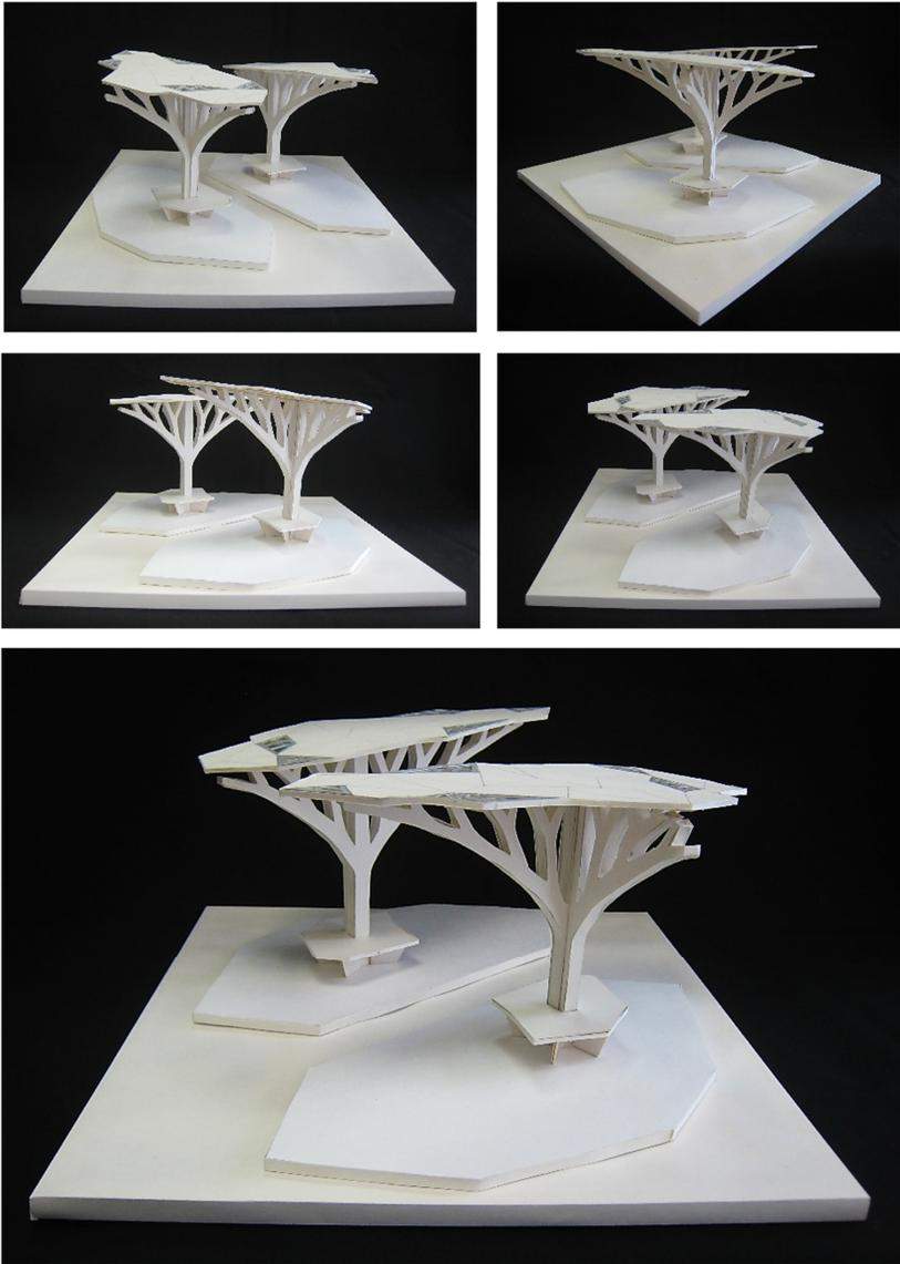
*Рисунок 2.35* — Теневые навесы с металлическим каркасом, покрытием из сотового /литого поликарбоната и закаленного стекла.
