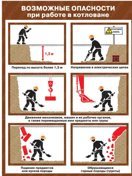
Рис. 2.1. Возможные опасности при работе в котловане
