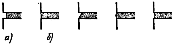
Рис. 42. Обработка швов кладки впустошовку (а), впдрез (б), расшивкой (в)
