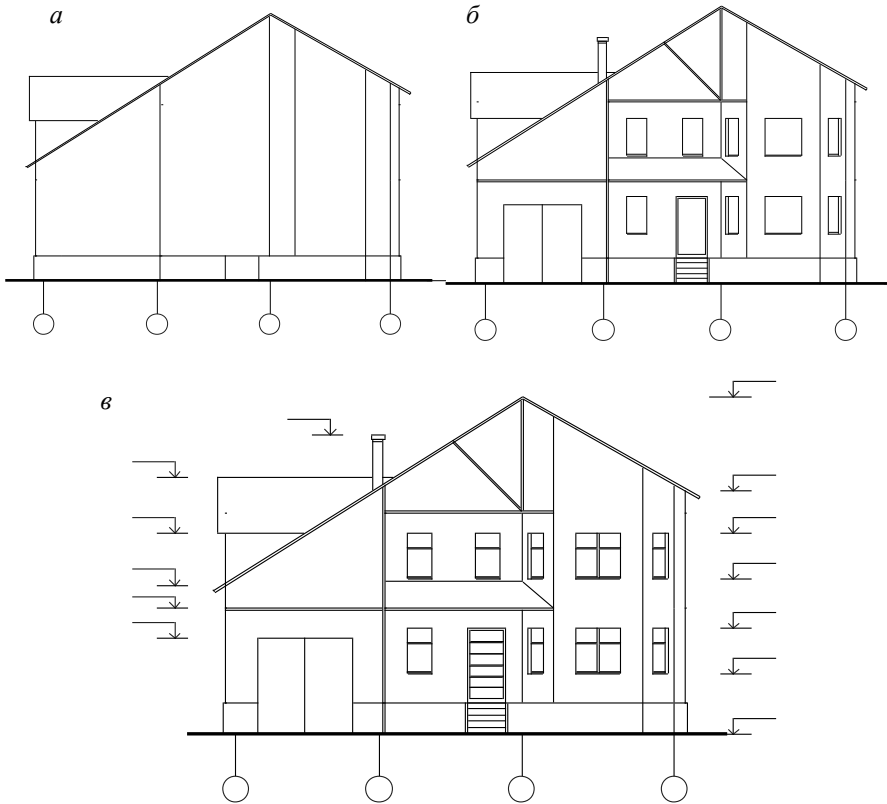
Рисунок 5.5 — Последовательность (а, б, в) вычерчивания фасада здания
