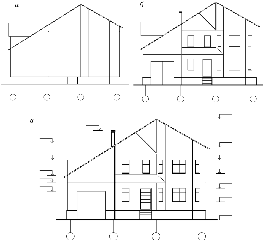
Рисунок 5.5 — Последовательность (а,б,в) вычерчивания фасада здания
