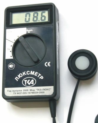
Рисунок 7.1 – Люксметр типа «ТКА-Люкс»
