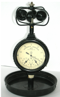
Рисунок 5.1 – Анемометр механический чашечный (А), крыльчатый (Б)
