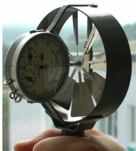
Рисунок 5.1 – Анемометр механический чашечный (А), крыльчатый (Б)
