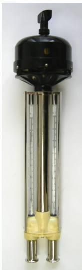
Рисунок 1.1 – Аспирационный психрометр Ассмана: а – общий вид психрометра; б – разрез; 1 – аспирационная головка; 2 – ключ механического привода; 3 – корпус; 4 – ртутные метеорологические термометры («сухой» и «влажный»); 5 – защита всасывающих трубок; 6 – всасывающие трубки; 7 – батист; 8 – термозащита; 9 – воздухопроводная трубка
