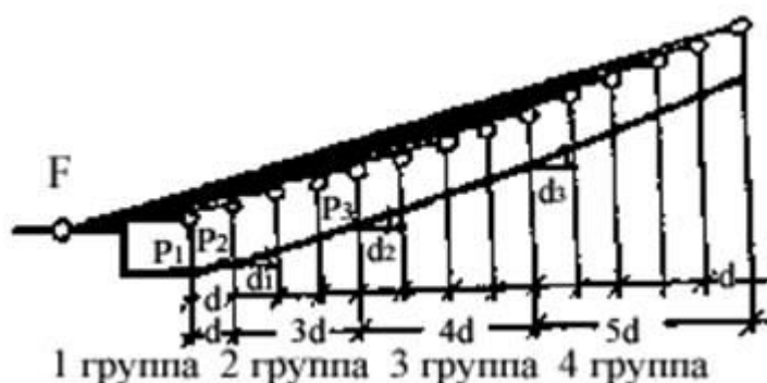
Рис. 9. Профиль подъема рядов в виде ломаной линии: P - точка перелома; углы \alpha_3 > \alpha_2 > \alpha_1
