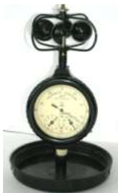
Рисунок 4.1 – Анемометр механический чашечный (А), крыльчатый (Б)
